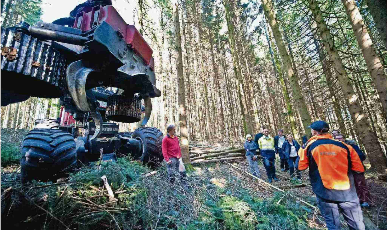
Ein riesiger Vollernter – so heisst das Ungetüm – fällt die Bäume, sägt die Stämme auf vier Meter lange Stücke und legt das Holz zum Transport bereit.
